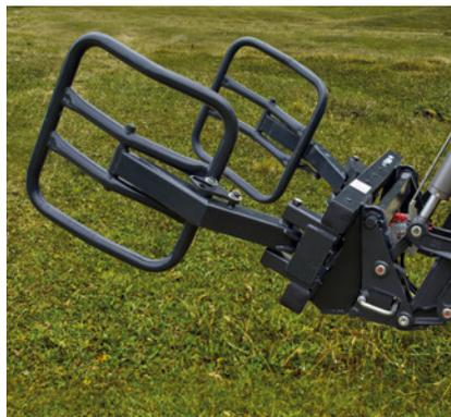
**2** Nagnite alat - brava se automatski uključuje.
