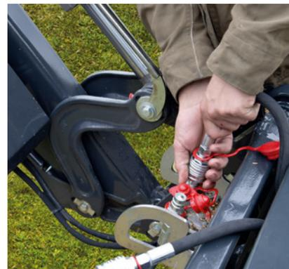
**3** Spajanje hidrauličkog priključka.
