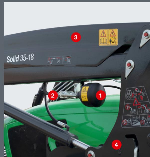
Comfort-Drive je zaštićen između drive-in stupa i zakretne ruke. Može se uključiti i isključiti preko zapornog ventila.
