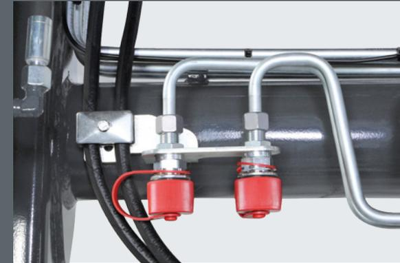
Učinkovito koristite hidraulične alate - zahvaljujući trećem upravljačkom krugu nije potrebna dodatna upravljačka jedinica.
